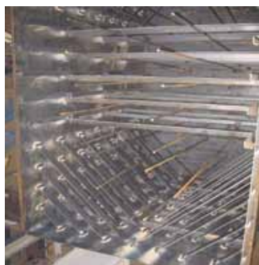
Bilden visar en tank invändigt, där syns stagen som är utmärkande för Extunas kvalitets tankar
